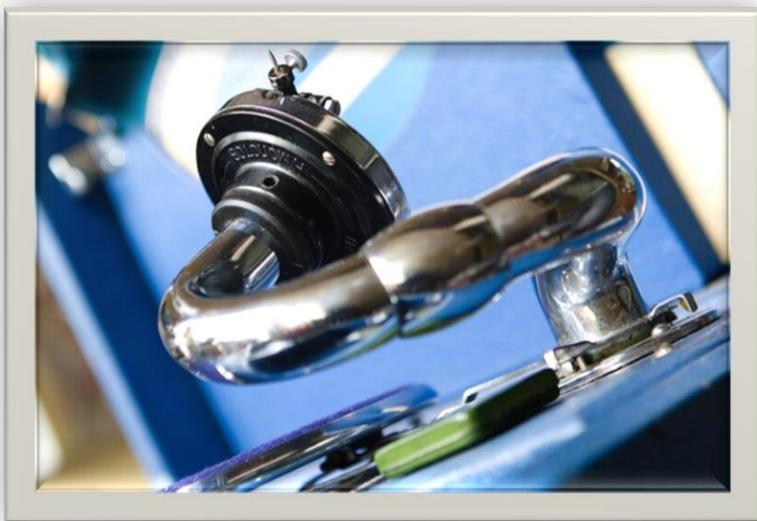
Патефоны той поры были механическими и приводились в действие посредством пружины. Одного завода хватало на прослушивание одной стороны пластинки. Этот аппарат не требовал подключения к электросети.
